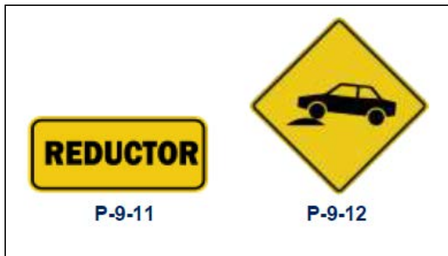
Figura 6. Detalle de recomendación de señalización vertical para una escuela con reductor
