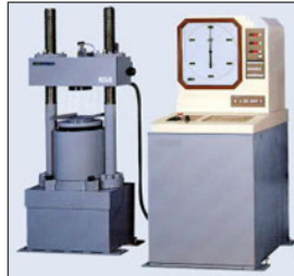
Maquina de Compactación del Concreto
