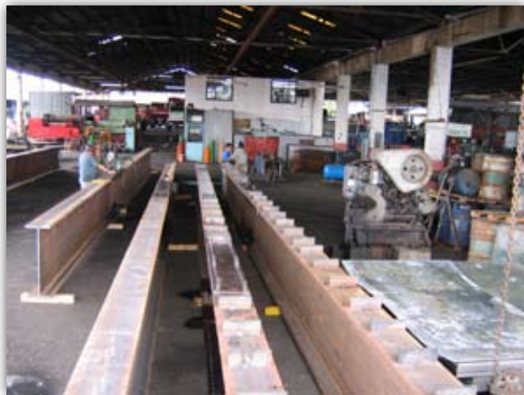
Ensamble de vigas para puentes en el Taller Central
