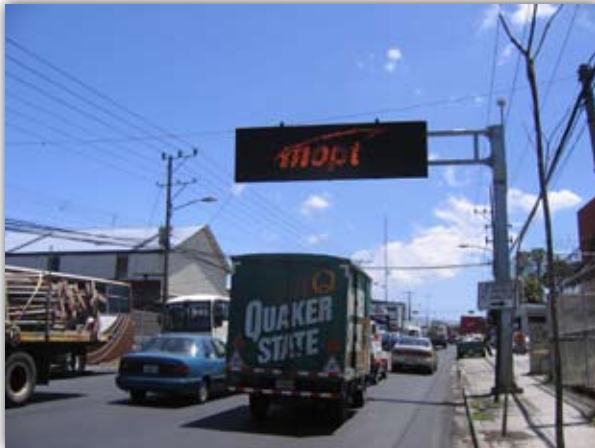
Pantallas de mensajes variables (para conteos vehiculares), distribuidas en 75 estaciones de medición.
