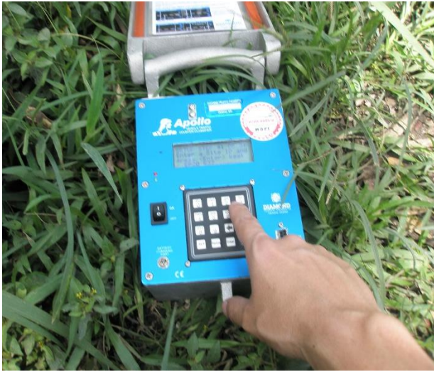
Figura 4: Contador de manguera utilizado por el MOPT
