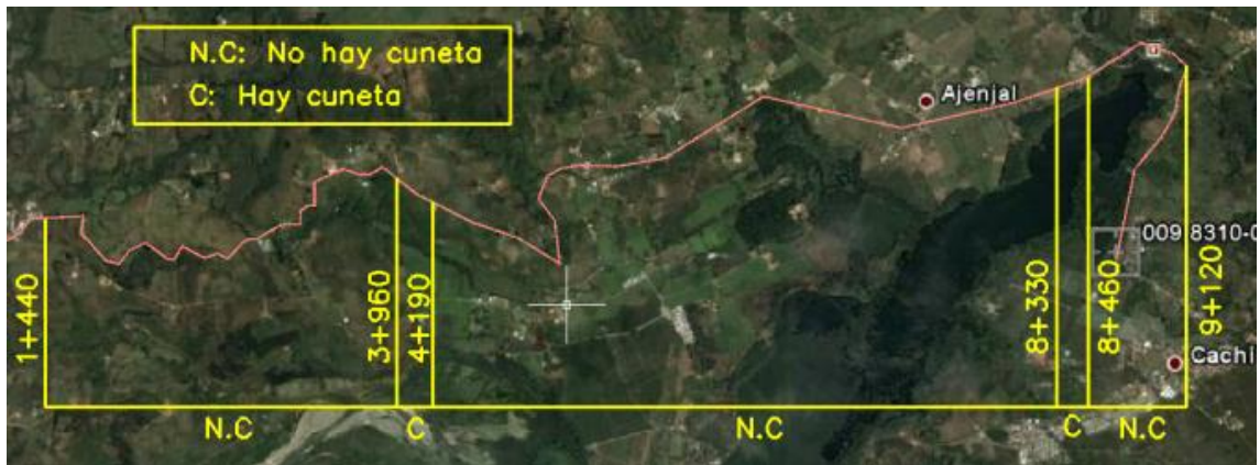
Figura 2. Áreas provistas y carentes de drenaje longitudinal en la ruta 224 (Fuente: Google Earth, con intervenciones del autor)
