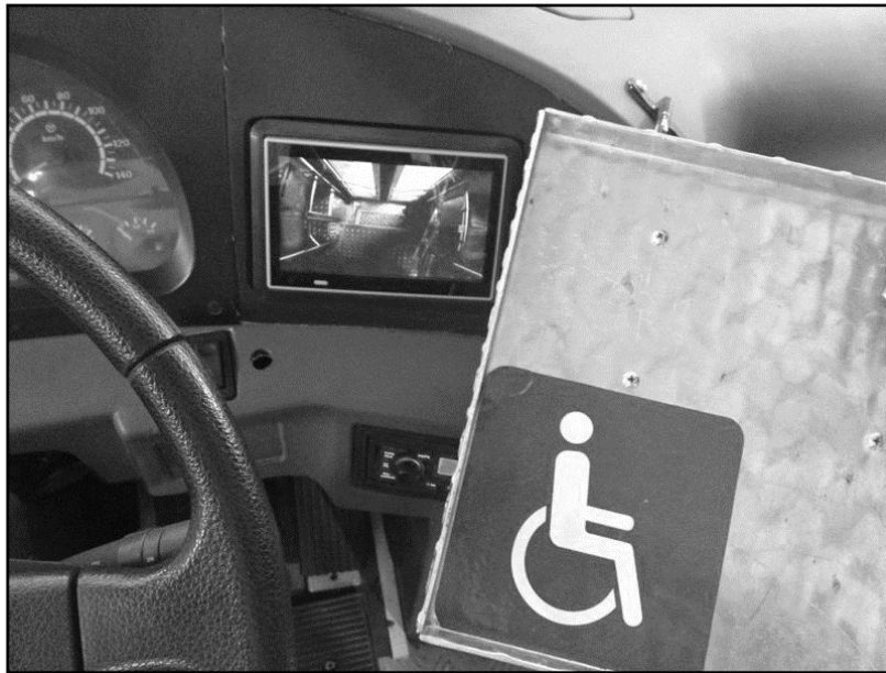
Figura 4.- Cámaras en el panel del bus de ATD que permiten al chofer observar si hay pasajeros descendiendo
