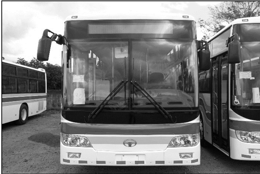
Figura 5.- Autobús con pantalla electrónica exterior de ATD
