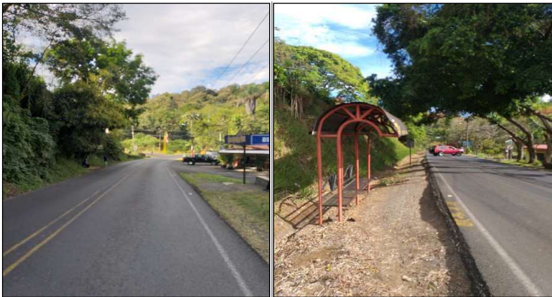
Figura 8. Parada de autobuses con escampadero, sin bahía.
