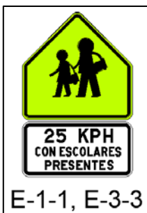
Figuras 14. Señales de proximidad a zona escolar
