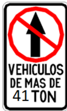
Figura 10. Plantilla para señal reglamentaria de Prohibido el Paso a Vehículos de más de 41 Toneladas de peso con carga
