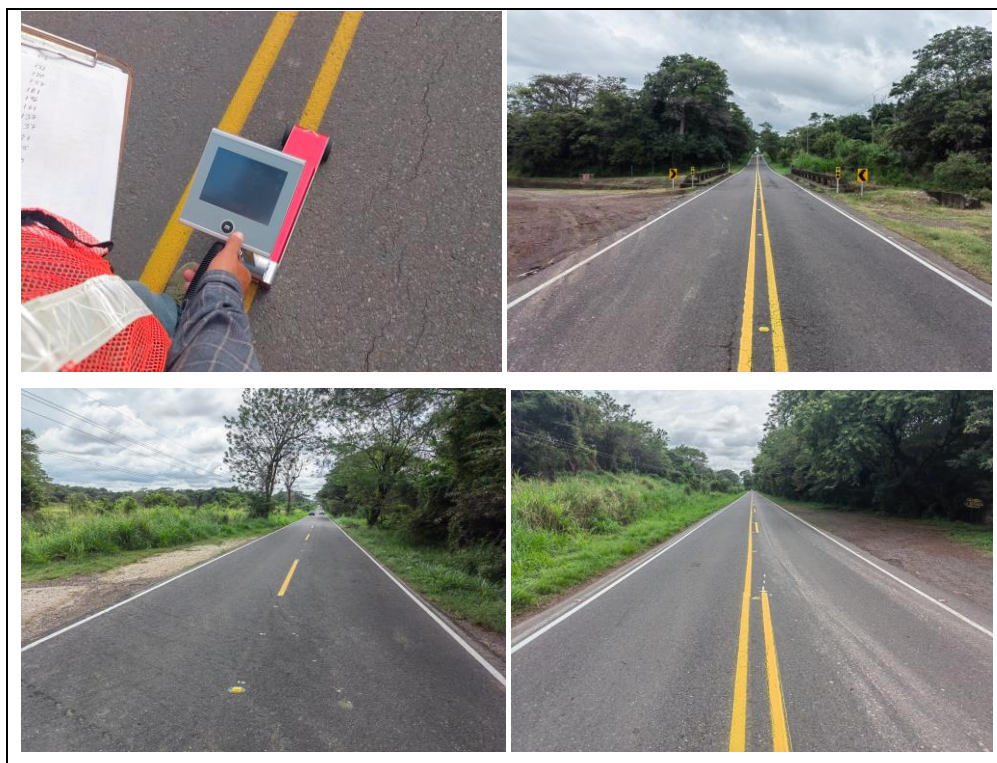
Figura 5. Toma de datos de demarcación horizontal con el uso del reflectómetro LTL-XL Delta
