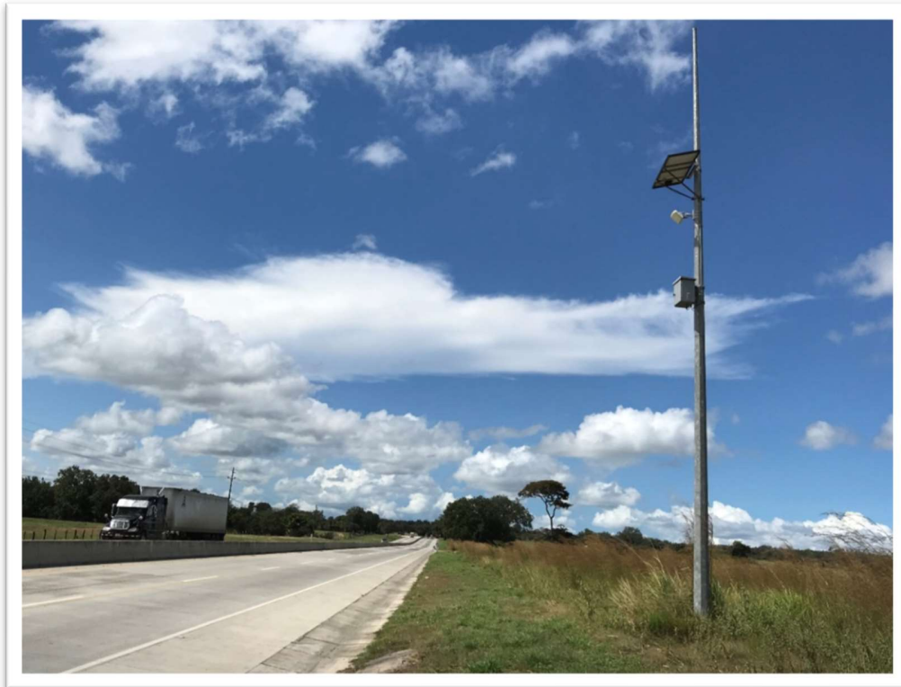
AFORO DE TRÁFICO EN BAGACES, CARRETERA INTERAMERICANA NORTE, MEDIANTE UN CONTADOR DE RADAR
