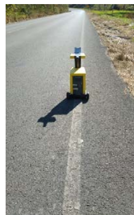
Figura 24. Medición de retroreflectividad horizontal en Ruta Nacional N° 34 con reflectómetro horizontal marca Delta, modelo LTL-XL standar
