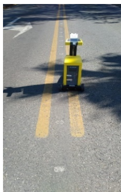
Figura 24. Medición de retroreflectividad horizontal en Ruta Nacional N° 34 con reflectómetro horizontal marca Delta, modelo LTL-XL standar
