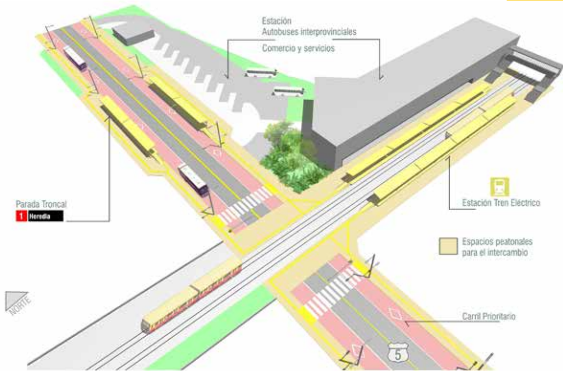
Imagen 56. Esquema de integración física entre modos. La integración física entre el Tren Eléctrico Metropolitano y el proyecto de Modernización del Transporte Público Modalidad Autobús se realiza en los Nodos de Integración. Fuente: SPS-MOPT, 2020.
