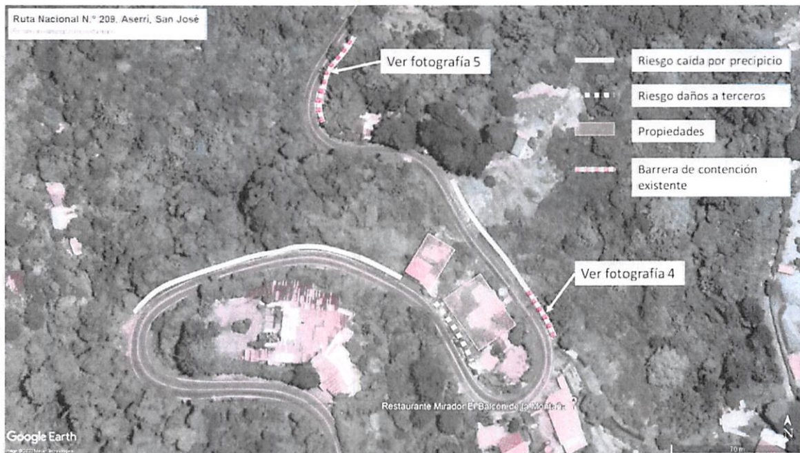
Figura 3 Puntos críticos por salida de la vía, Aserrí, San José. Fuente: Google Earth.
