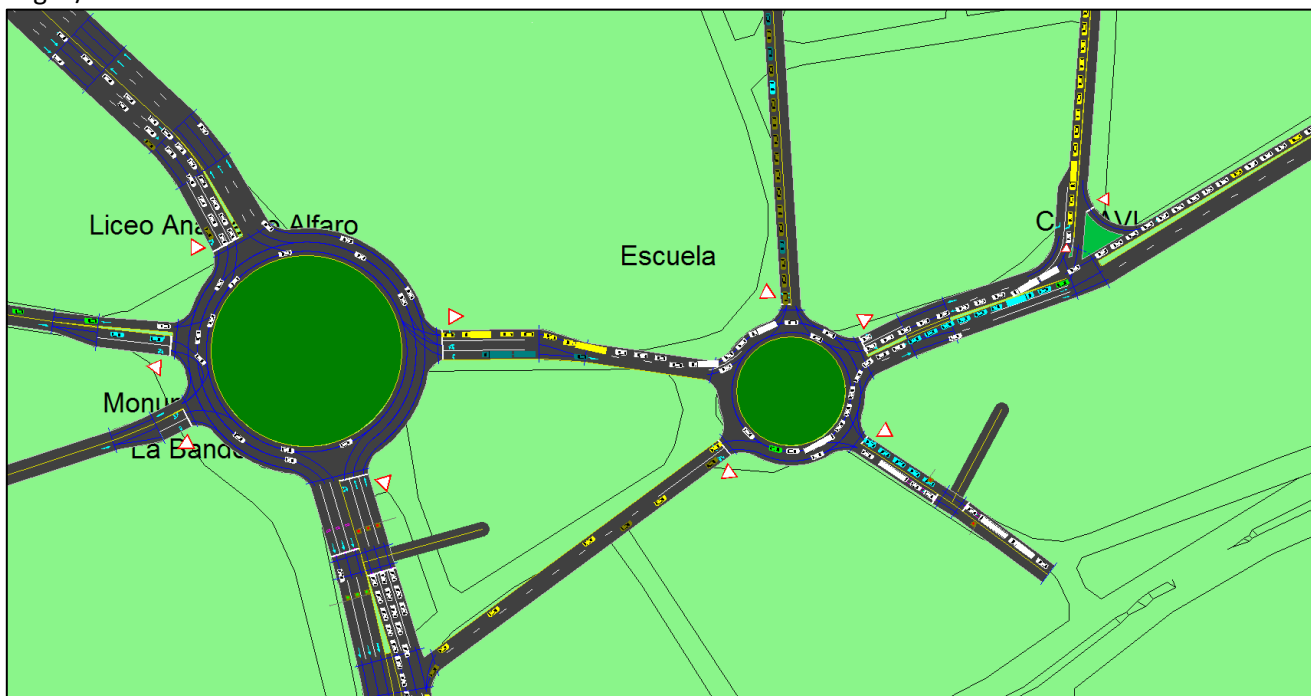
Figura 4 Simulación con Simtraffic de situación actual de rotonda la Betania, Betania e Intersección del CONAVI.
