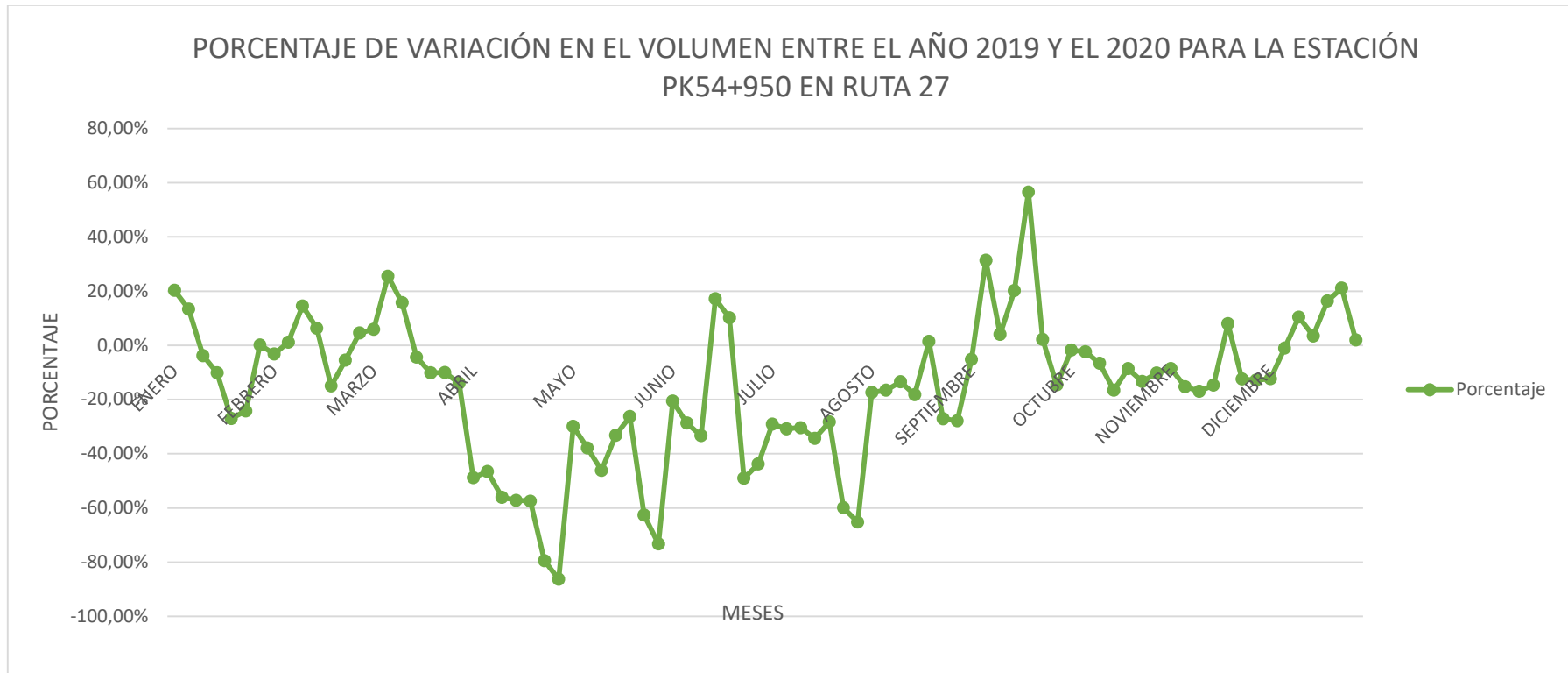
Figura 30: Porcentaje de variación en el flujo vehicular por efecto del COVID en estación PK 54+950. Fuente: Información elaborada por J.C. Zúñiga a partir de datos suministrados por el CNC, marzo 2021.
