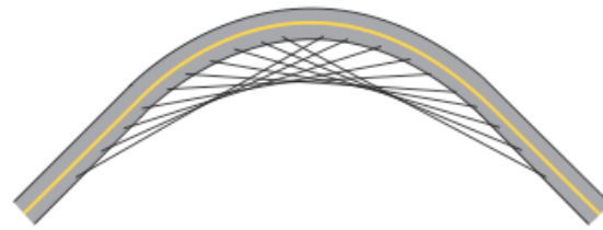
Figura II-9 Distancia de visibilidad de parada a lo largo de una curva horizontal y su relación con el despeje lateral
