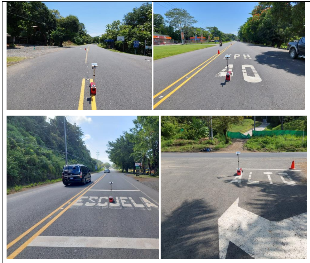
Figura 5. Toma de datos de demarcación horizontal con el uso del reflectómetro LTL-XL Delta
