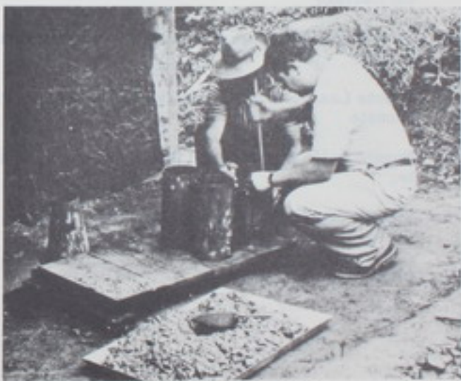
Manufactura de probetas de hormigón para ensayar a la compresión.
