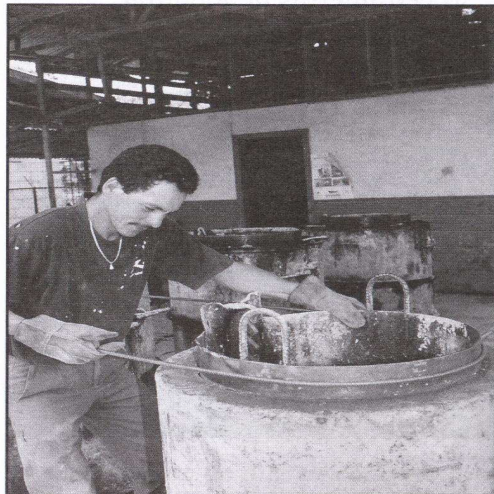
Figura 17 Confección de aros con un cilindro de metal.
