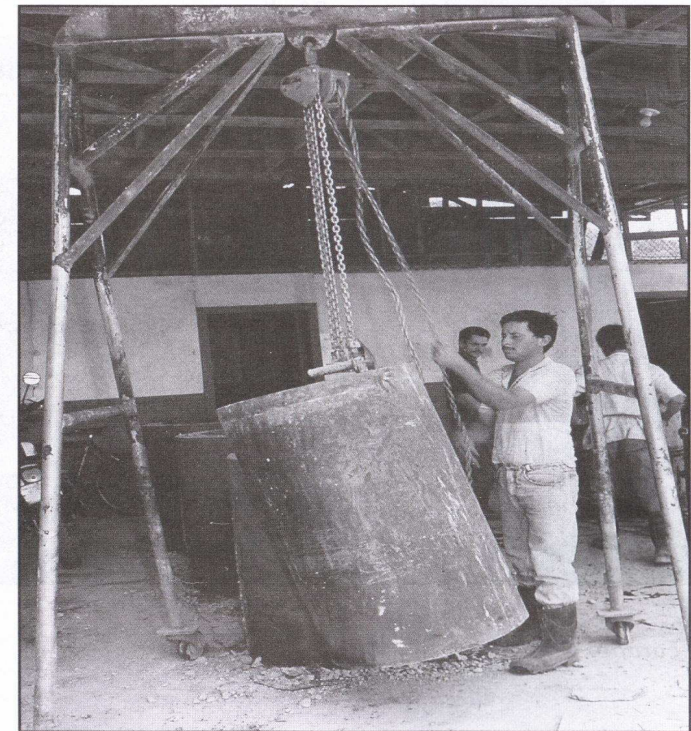
Figura 24 Levantamiento del núcleo del molde con el tecle.
