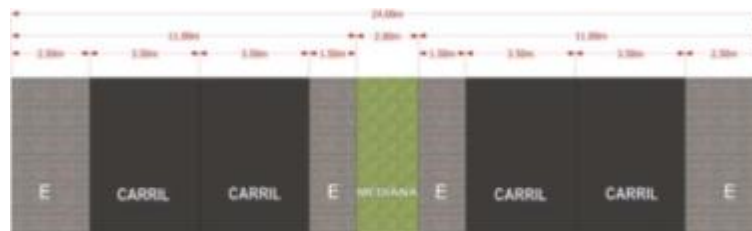
Figura 38. Red de Alta Capacidad – 24.00 mts
