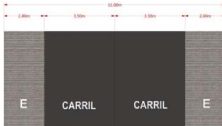
Figura 36. Sección transversal Distribuidores Regionales – 11 m.
