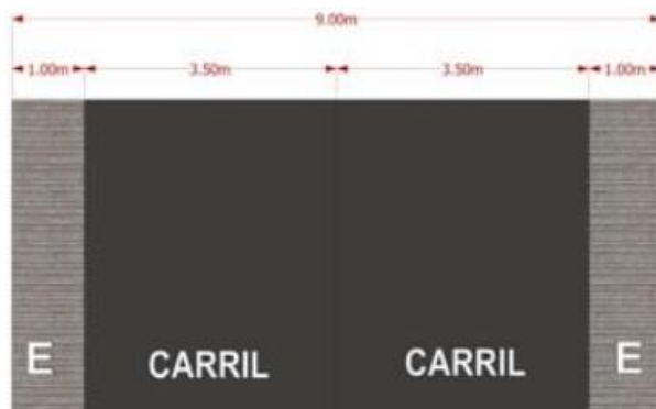
Figura 34. Sección transversal Conectores de Integración Territorial - 9 m.
