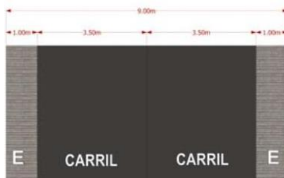
Figura 33. Sección transversal Red Básica de Acceso
