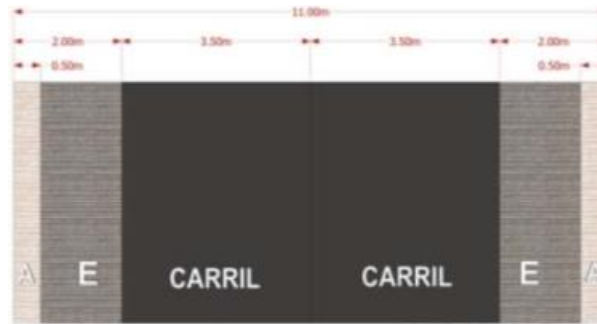
Figura 35. Sección transversal Conectores de Integración Territorial – 11 m.
