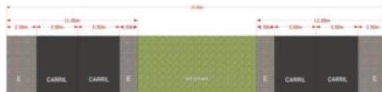
Figura 39. Red de Alta Capacidad – 32.00 mts
