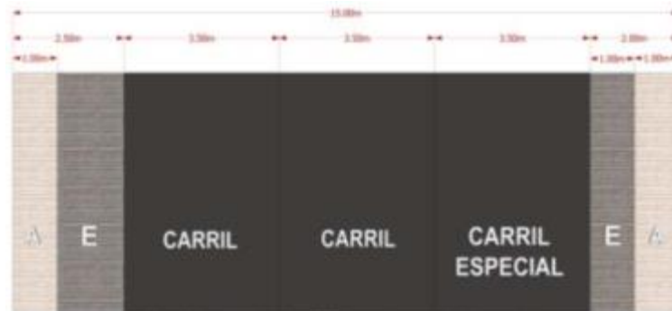
Figura 37 Sección transversal Distribuidores Regionales – 15 m.
