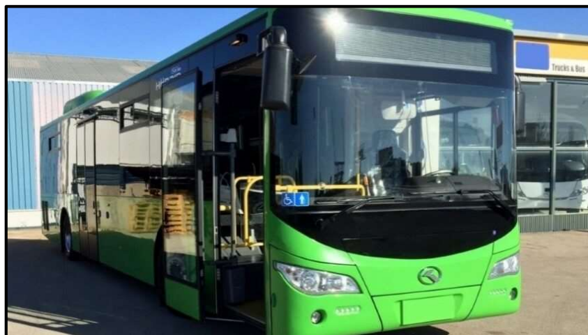
Figura 14: Autobús tipo urbano propulsado por motor de GLP
