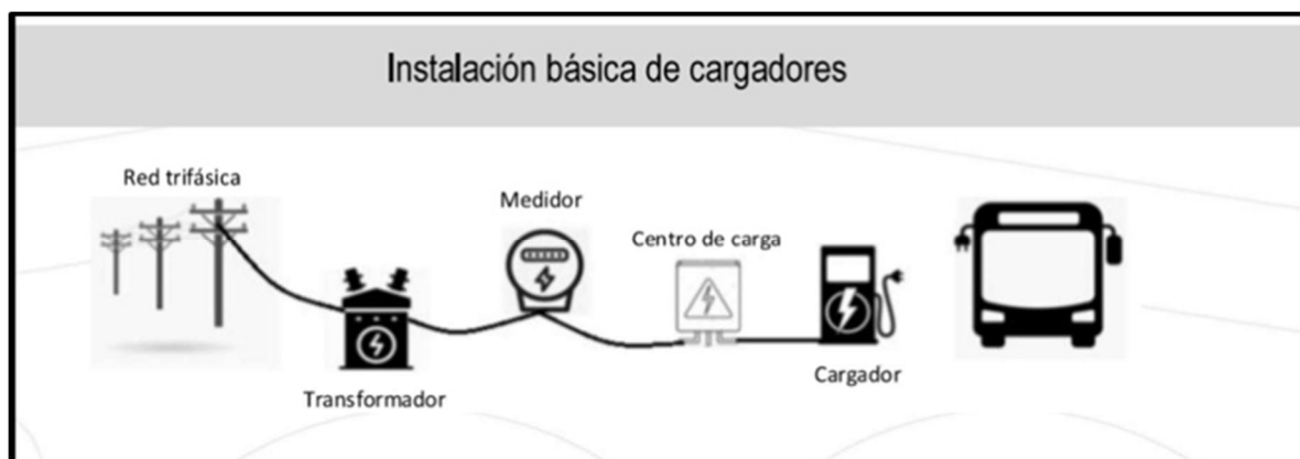
Figura 12: Infraestructura de carga, correcta instalación
