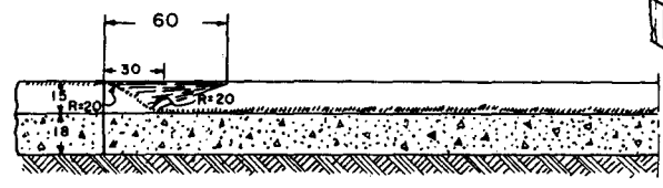
ELEVACION CORTE EN LA LINEA DE CUNETETA.
