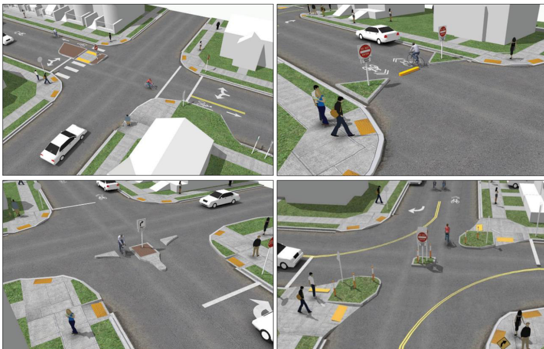
Figura 19. Desviador de tránsito para exclusión de flujos motorizados.
