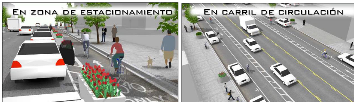
Figura 34. Zona de amortiguamiento en ciclovías Fuente. Adaptado de NACTO, 2011.
