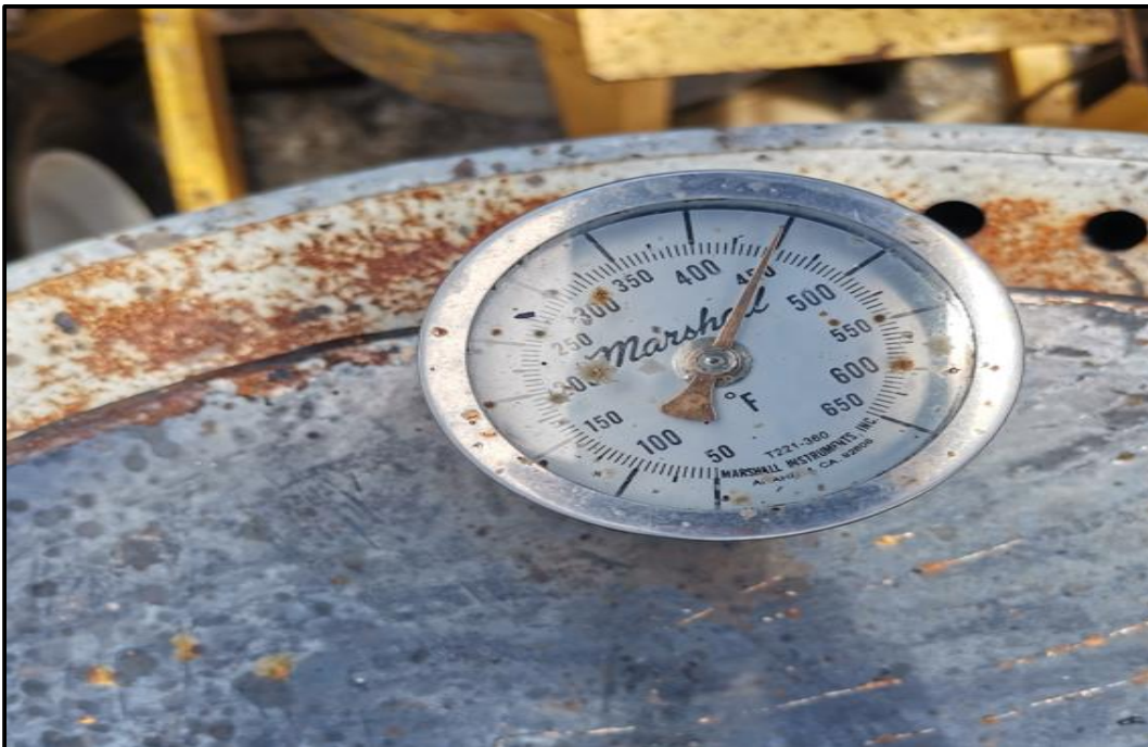
Imagen N° 9. Temperatura del bituminoso utilizado.
