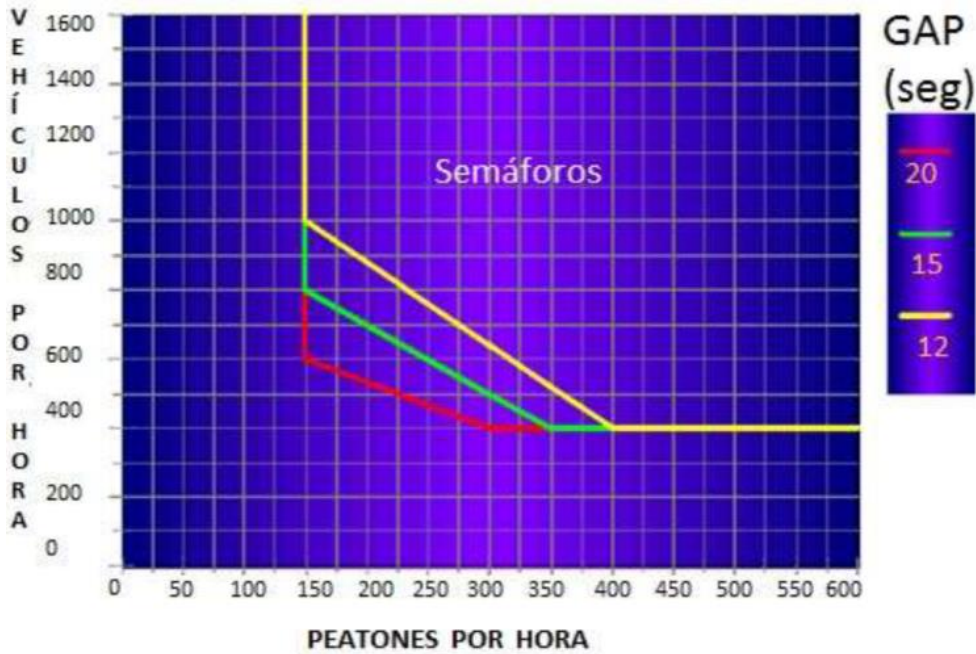
Figura 6 Volúmen mínimos de peatones y vehículos por hora. Fuente: (Manual Centroamericano de Dispositivos Uniformes para el Control de Tránsito, 2014, cap.5, p. 26).
