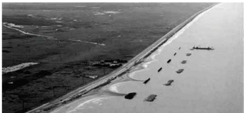
Fig. 6-10 Sistema de rompeolas. Extraído de (AASHTO, 2006)
