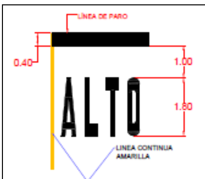
Figura 22. Detalle de los letreros de ALTO para velocidades menores de 60 KPH (valores en metros).
