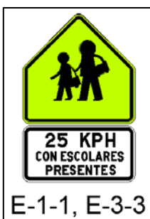
Figuras 13. Señales de proximidad a zona escolar
