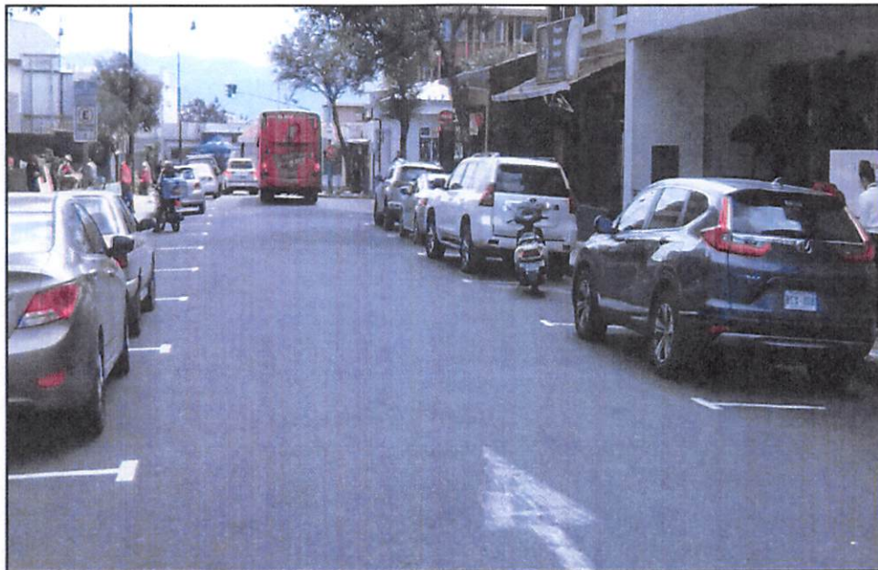
Figura 5 Sector de Calle 15, presencia de zonas de estacionamiento en ambos lados de la vía, reduciendo la capacidad de almacenamiento y tránsito vehicular en un único carril, vista Norte-Sur.
