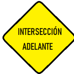
Figura 13. Plantilla para señal de INTERSECCIÓN ADELANTE
