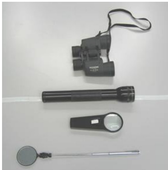
Figura 2-3 Herramientas para inspección visual
