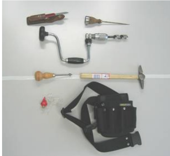
Figura 2-2 Herramientas para inspección general
