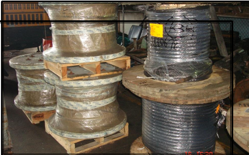
Cable acero grúa
