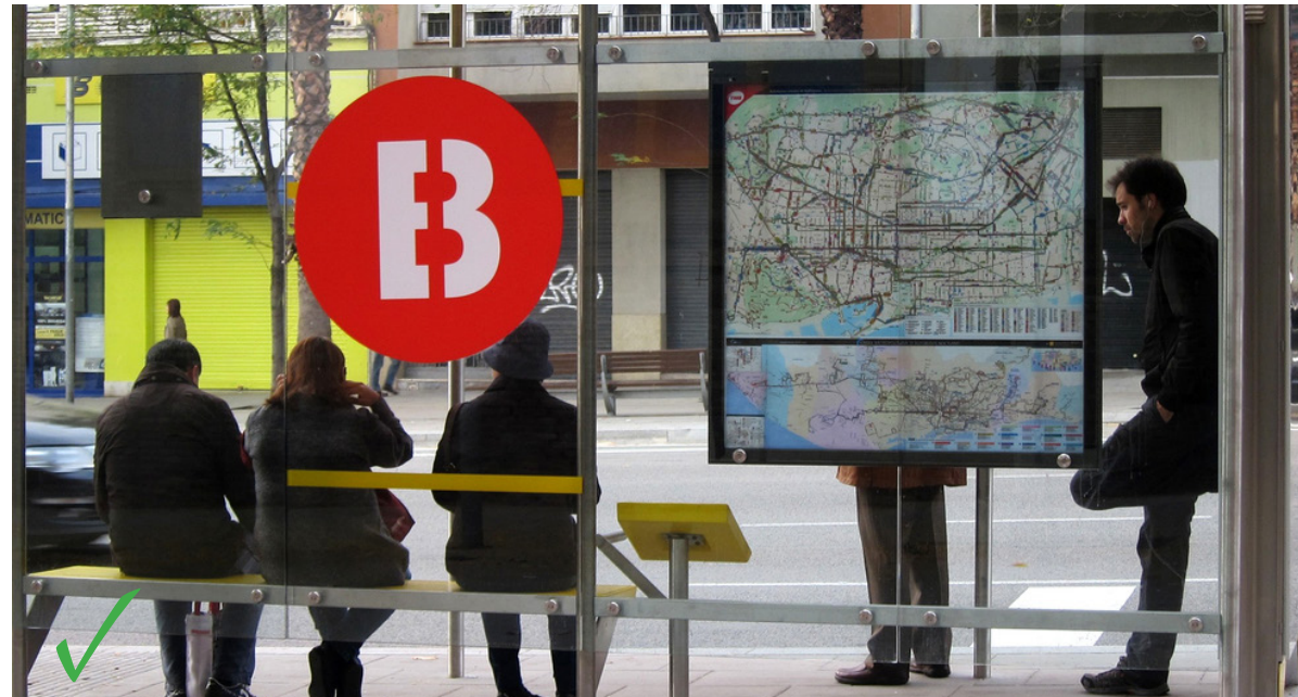
Parada de autobús que incluye elementos de resguardo, materiales transparentes, señalización de rutas, espacio para sentarse y espacio para sillas de ruedas.
