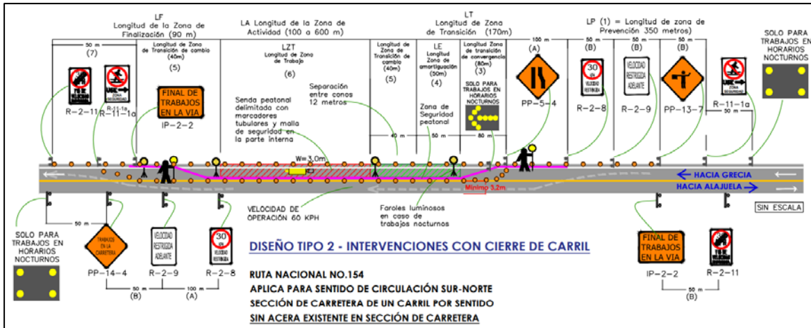
Figura 8. Componentes de las zonas de control de tránsito vehicular propuesto trabajos con cierre parcial Fuente: Propuesta de PMT, consultora RQ
