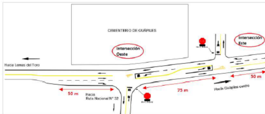
Figura 10. Ampliación propuesta para la solución final de los semáforos en las intersecciones de la zona de estudio.
