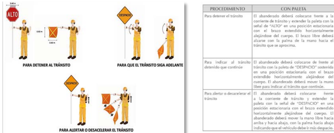
Figura 3. Tipo de señales de mano para control con abanderado y su procedimiento.
