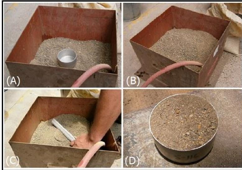
Figura 9: Proceso para determinar el peso volumétrico de las muestras ensayadas a escala reducida.
