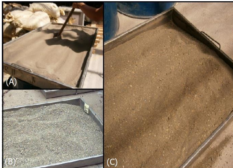
Figura 7: Mezcla de arena de playa (A) con arena de Río (B), para obtener una mezcla de proporción 50/50 (C)
