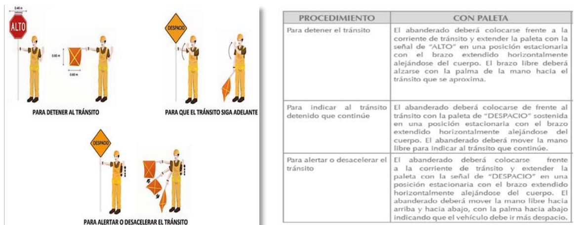
Figura 3. Tipo de señales de mano para control con abanderado y su procedimiento.
