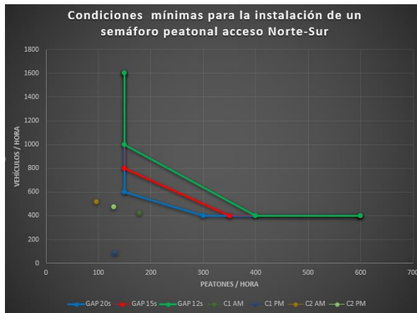
Figura 16 Condición C, Criterio para la instalación de un semáforo peatonal, acceso Norte, Hospital Metropolitano, Pozos de Santa Ana, Ruta Nacional N°310
