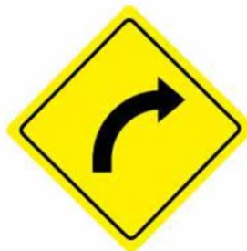
Figura 16. Plantilla para señal de Curva derecha
