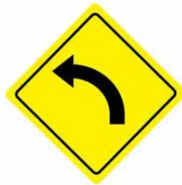
Figura 15. Plantilla para señal de Curva izquierda
