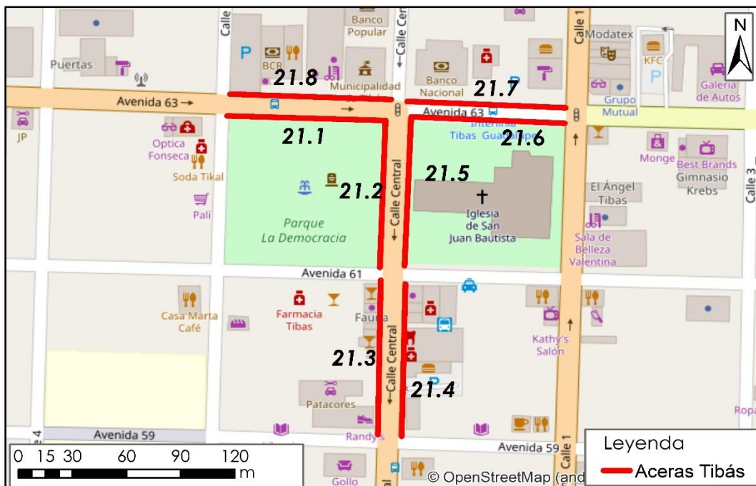
Figura 25. Ubicación del nodo 21, e identificación de sus tramos de aceras
