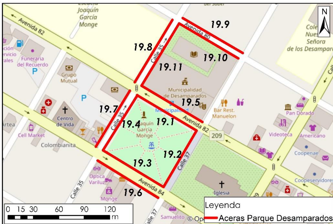
Figura 23. Ubicación del nodo 19, e identificación de sus tramos de aceras
