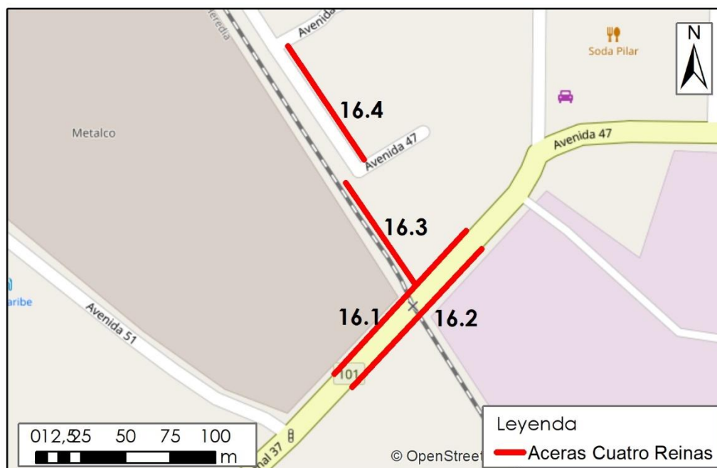
Figura 20. Ubicación del nodo 16, e identificación de sus tramos de aceras
