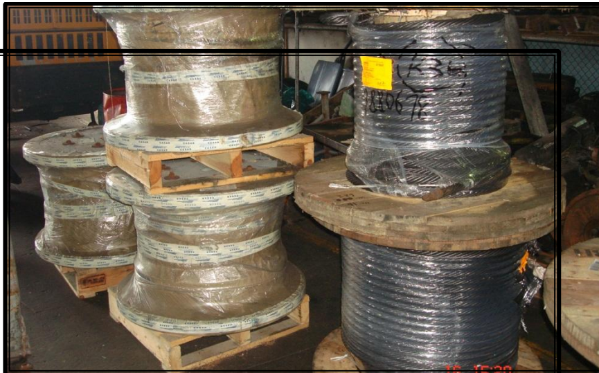
Cable acero grúa
