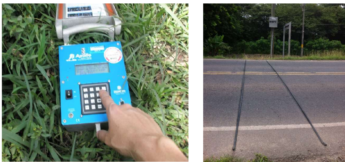
Figura 4: Contador de manguera utilizado por el MOPT
