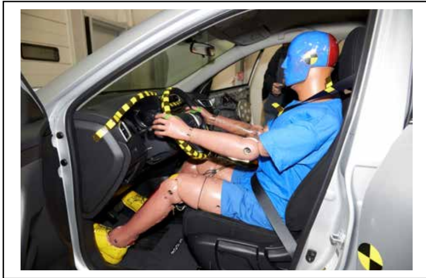
Ilustración 2-24. Maniquí antropomórfico para pruebas de colisiones de vehículos
