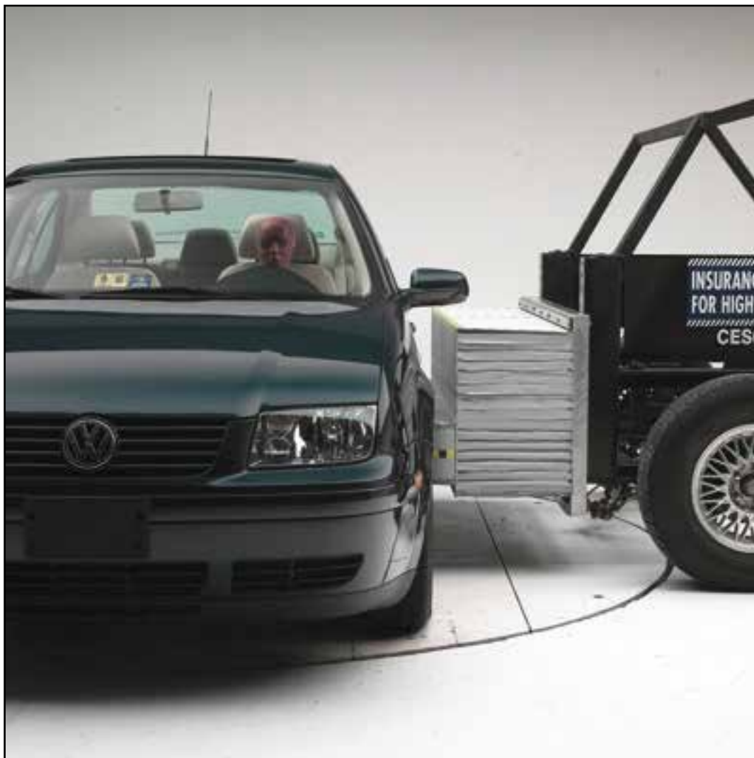
Ilustración 2-41. Prueba de choque lateral contra una barrera móvil
