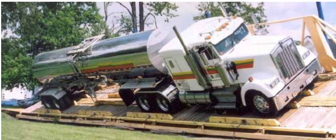
Ilustración 4-92. Prueba de estabilidad de los camiones cisterna
