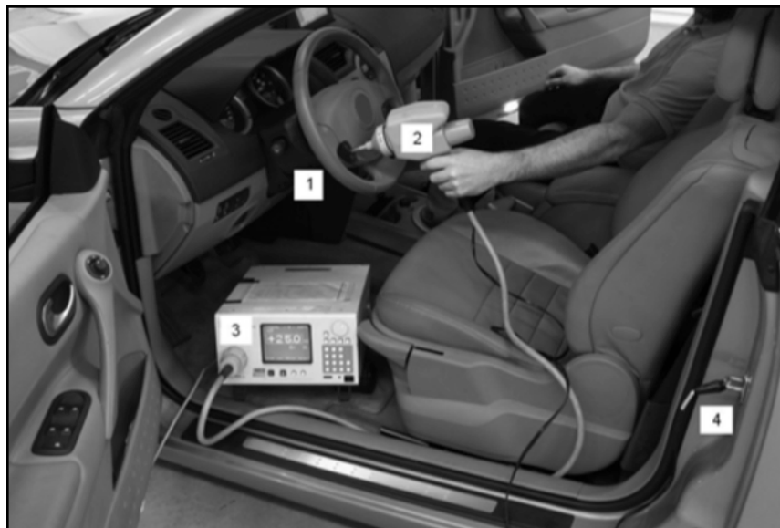
Ilustración 4-77. Prueba de inmunidad ante perturbaciones producidas por descargas electrostáticas
