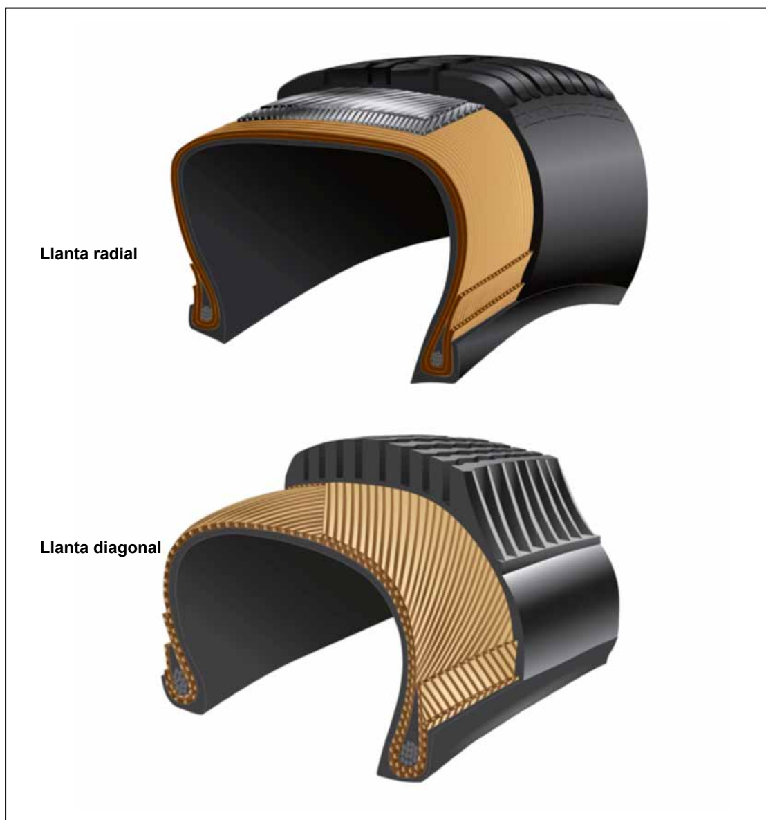
Diferencias entre las llantas radiales y neumáticas
