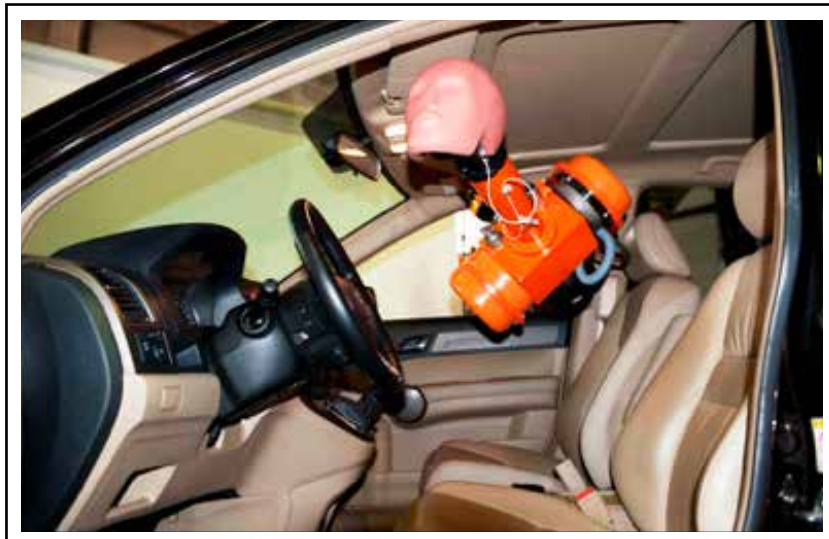
Ilustración 2-25. Prueba de choque de cabeza con movimiento libre
