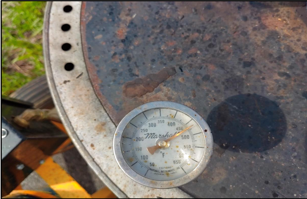
Imagen N° 9. Temperatura del bituminoso utilizado.
