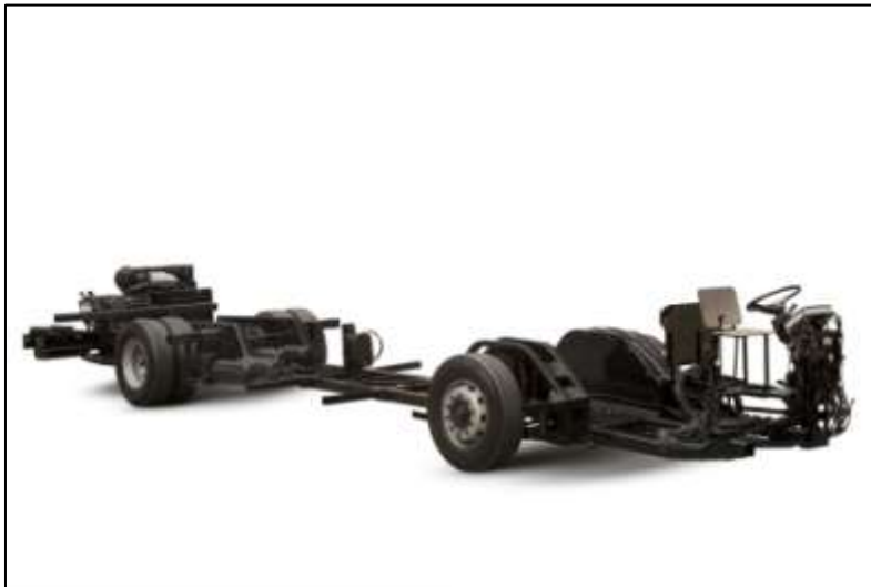
Fotografía 7. Chasis de piso bajo (tipo “low entry”),
