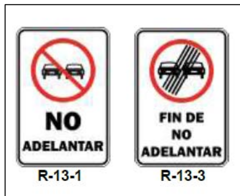
Figura 1. Señalamiento para zonas prohibidas de adelantamiento
