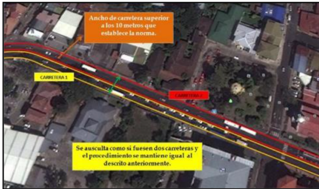
Figura 6.8 Procedimiento para carreteras anchas
